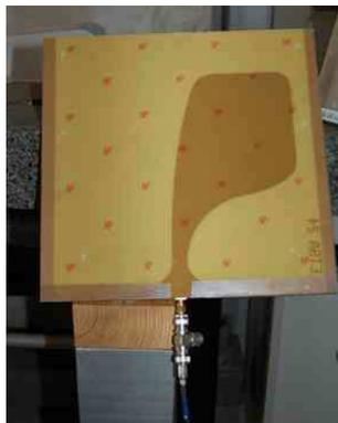
Figure 9.2. Antenne planaire imprimée, bande de détection 10-1200MHz. L'antenne a été réalisée au Laboratoire d'Electronique Antennes et Télécommunications (LEAT) de l'Université de Nice-Sophia Antipolis.
